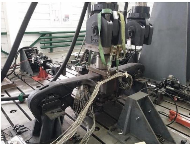
Рис. 12. Приложение вертикальной нагрузки в места опирания пружин рессорного комплекта
