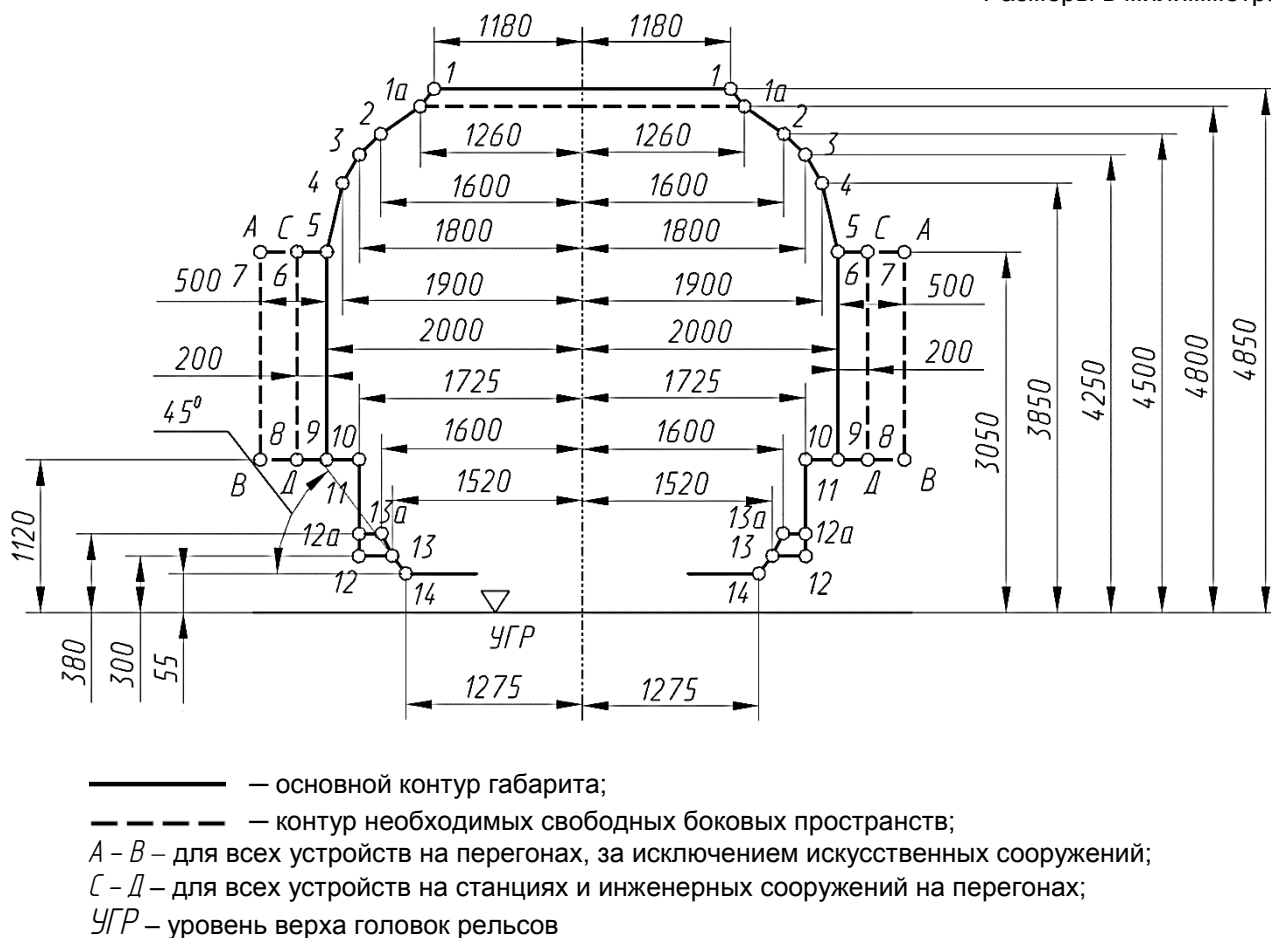
Рисунок В.1 – Верхнее очертание габарита 1-СМ
