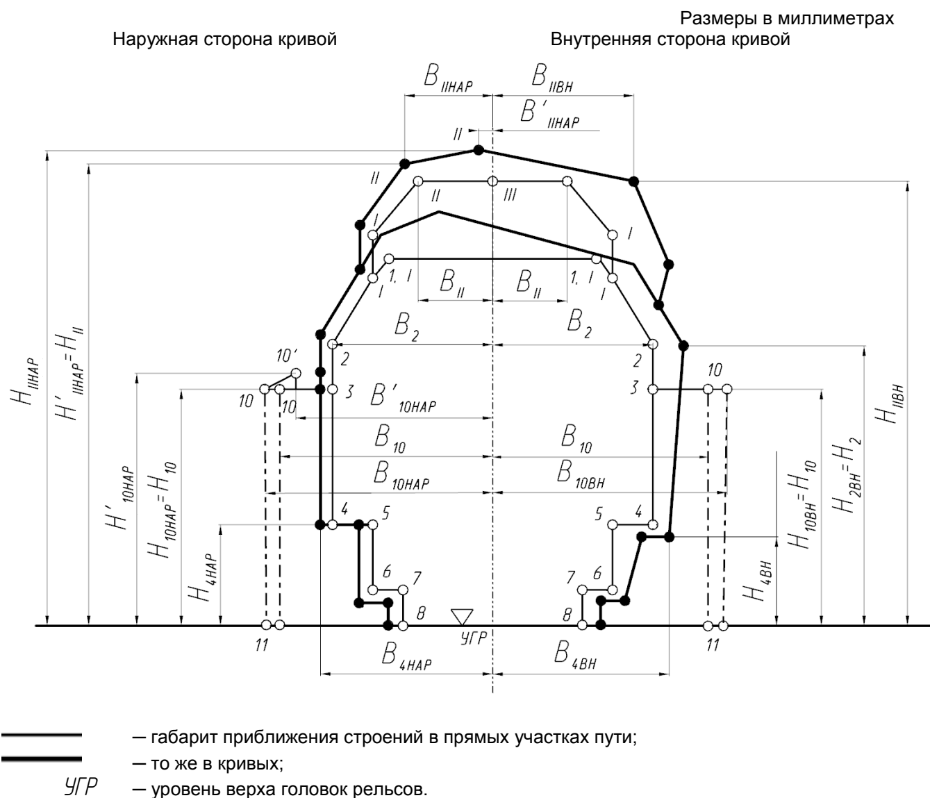
Рисунок Е.1 – Принцип построения габарита приближения строений \zeta в кривых по проектным нормам
