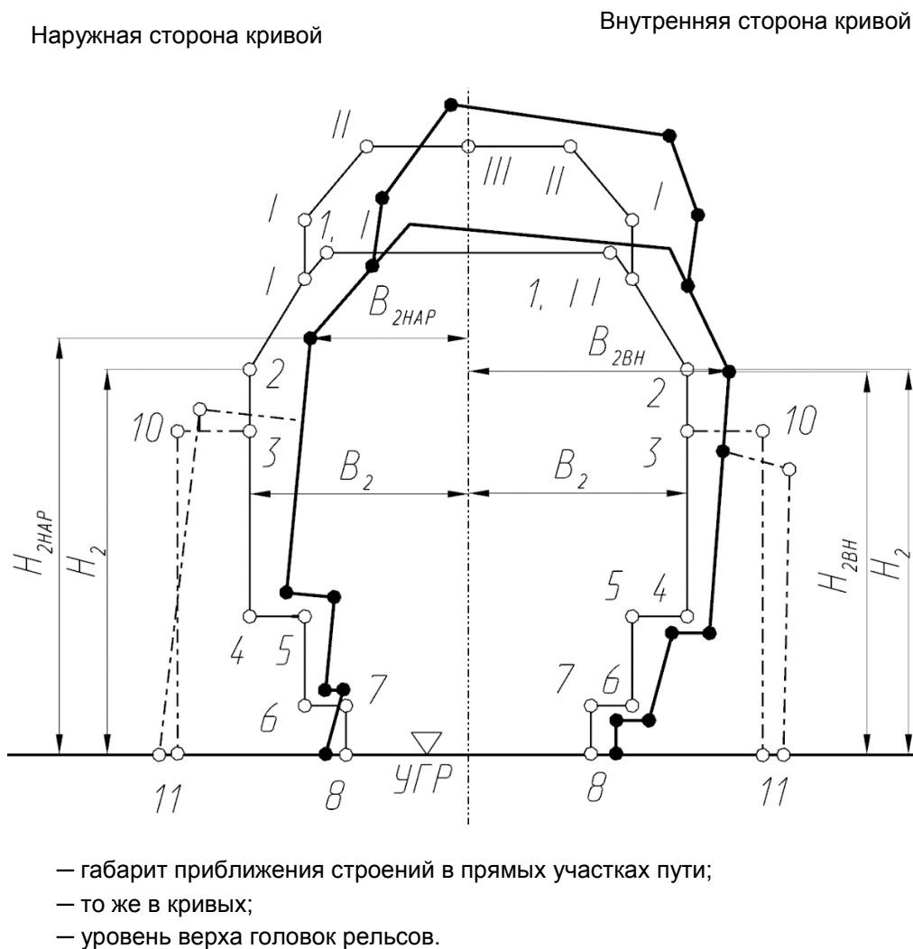
Рисунок Е.2 – Принцип построения габарита приближения строений \zeta в кривых по эксплуатационным нормам
