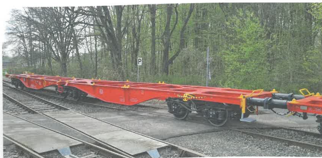
Рис. 1. Вагон-платформа типа Sggrs
