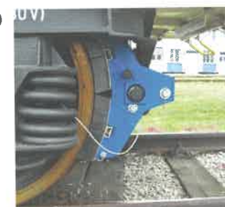
Рис. 5. Подготовка к ходовым тормозным испытаниям, где: а) опытный состав; б) тензометрический башмак; в) датчик давления
