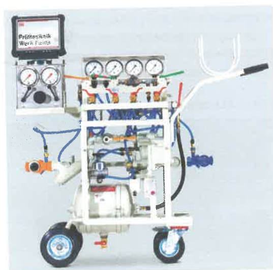
Рис. 4. Установка PDR-5 для проверки тормоза
