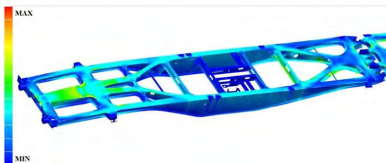
Рис. 9. Напряженное состояние, реализуемое в секции платформы при растяжении силой 1,5 МН с учетом веса контейнеров и конструкции
