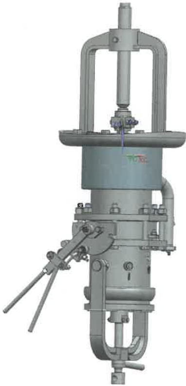
Рис. 2. Устройство нижнего слива с дисковым затвором Ду-200
