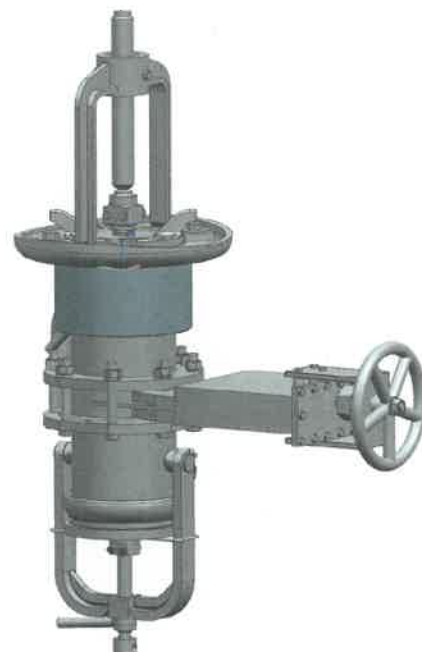
Рис. 6. Устройство нижнего слива с задвижкой шиберной НЗК Н1-200-10-Р-УХЛ1
