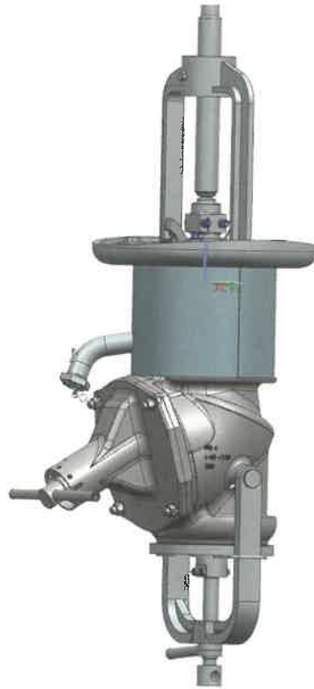
Рис. 3. Устройство нижнего слива с затвором СТХ3.492426.004
