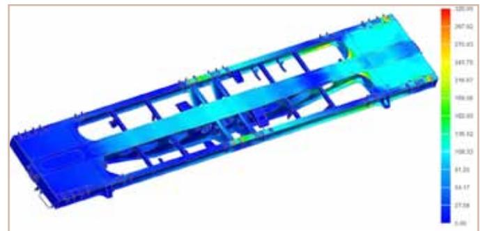
Рис. 7. Распределение эквивалентных напряжений при ударе, загрузка по схеме Б, МПа
