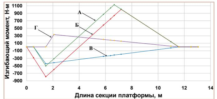
Рис. 5. Эпюры изгибающих моментов, возникающих от совместного воздействия, дополнительно учитывающего вертикальную составляющую продольной силы инерции контейнеров при ударном воздействии (3,5 МН) для основных схем загрузки
