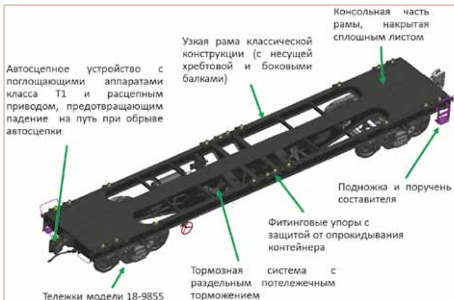
Рис. 2. Конструкция вагона-платформы модели 13-6724
