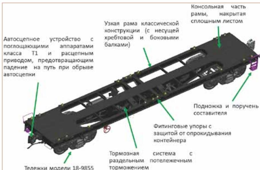
Рис. 2. Конструкция вагона-платформы модели 13-6724
