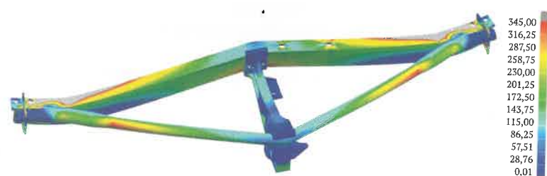
Рис 4. НДС при приложении силы, возникающей при нажатии колодок, к триангелю (напряжения приведены в МПа)
