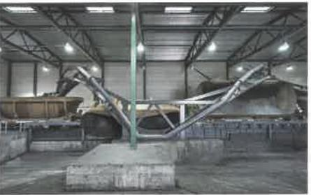
Рис. 8. Системы разгрузки Helix Dumper компании Kiruna Wagon
