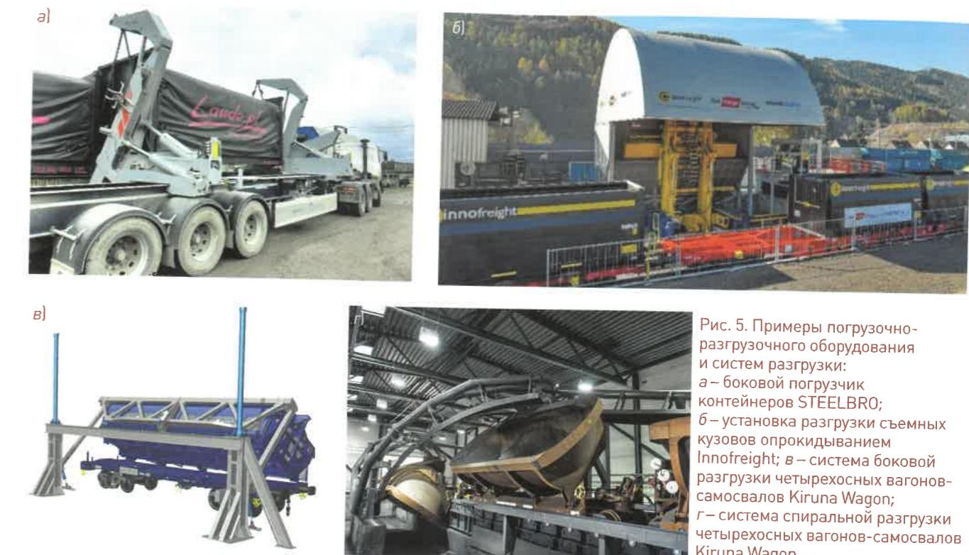
Рис. 5. Примеры погрузочно-разгрузочного оборудования и систем разгрузки:
