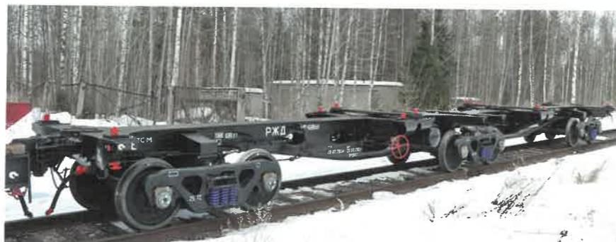
Рис. 6. Общий вид специализированного вагона-платформы для контейнеров и сменных кузовов модели 10-630
