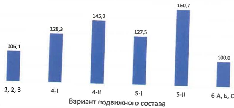
Рис. 9. Стоимость перевозки зерна в различных вариантах подвижного состава без смены специализации в процентах от наименьшей стоимости
