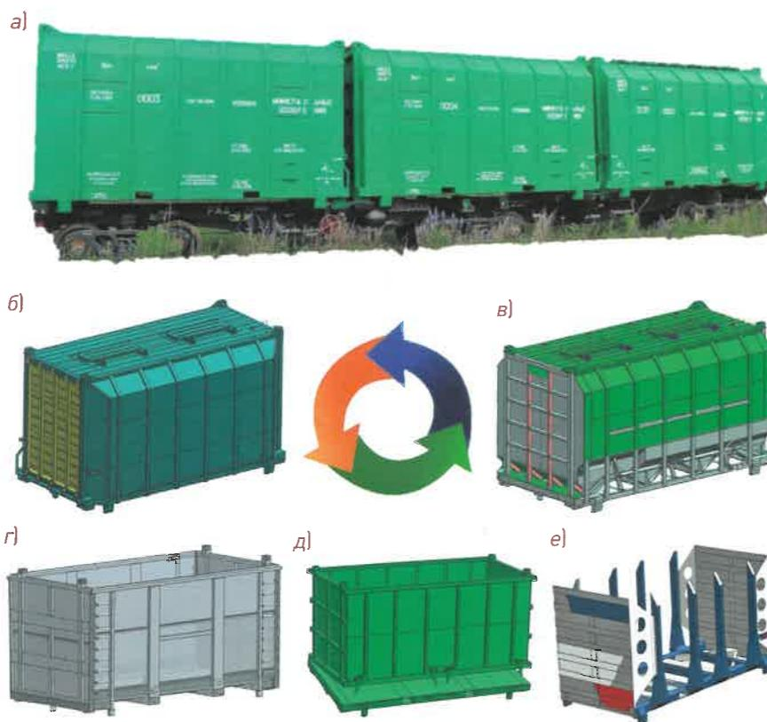
Рис. 7. Специализированный вагон [а] и его сменные кузова [б-е]:
